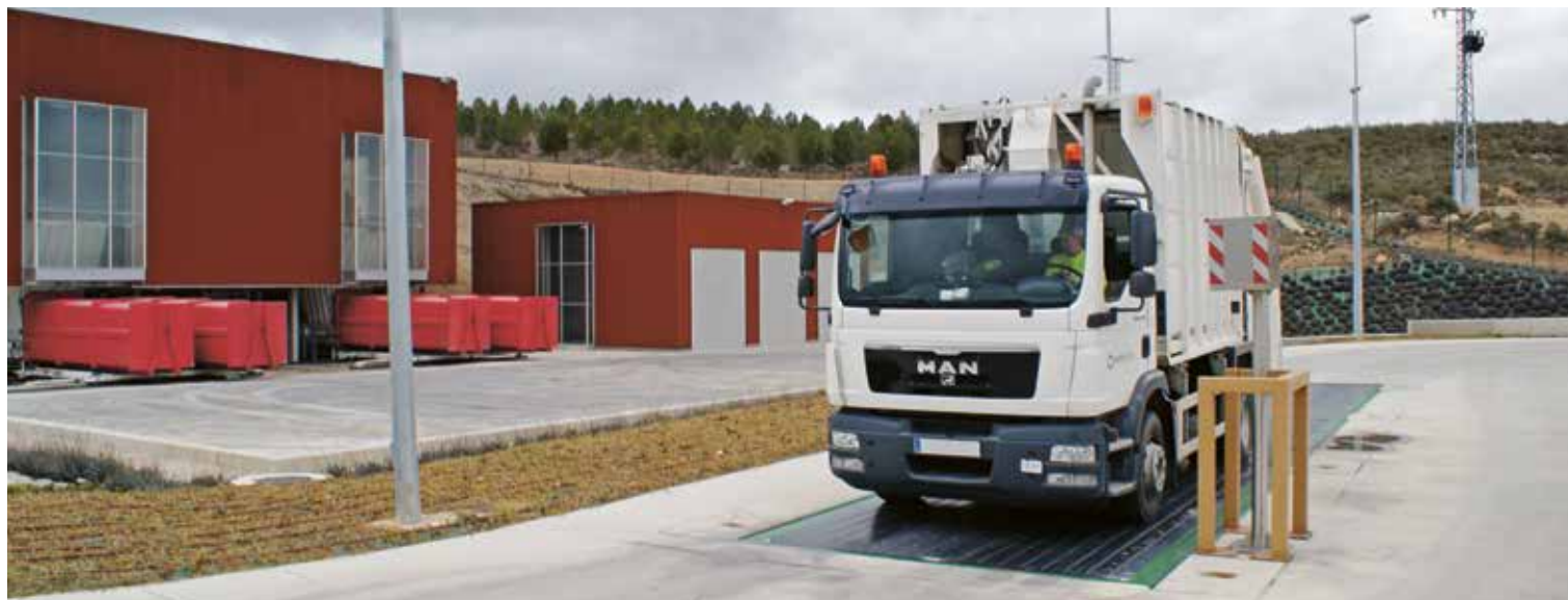
Un camión pesa su carga en la báscula de la estación de transferencia de Zona Media.
